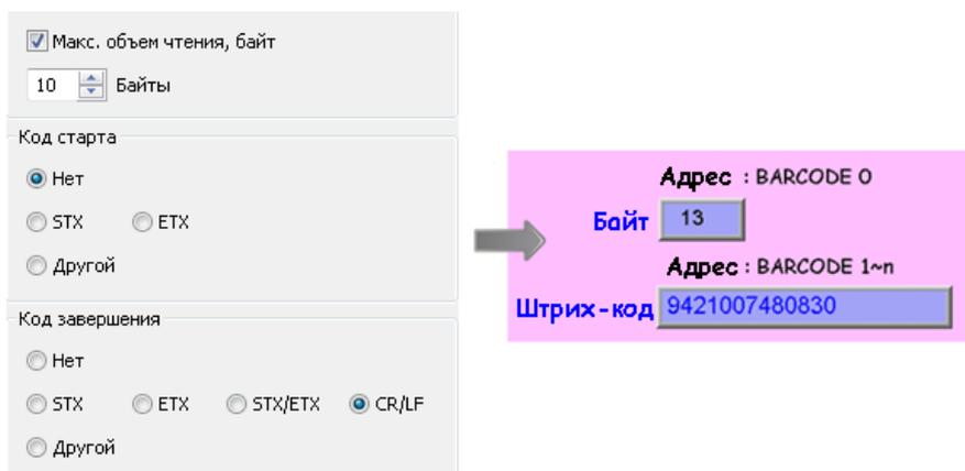
В этом примере данные, хранящиеся в адресе считывателя штрих-кода, перечислены в следующей таблице:
